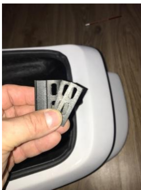
Vymedzujúce podložky vodítka .(nastavujú výšku vodítka )
