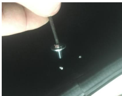
Montáž vrchného dekla. Imbus 3mm
