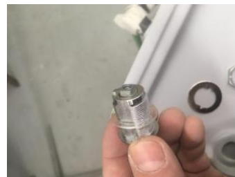
Odstrániť silikónovú podložku od spodu aj z vrchu .
